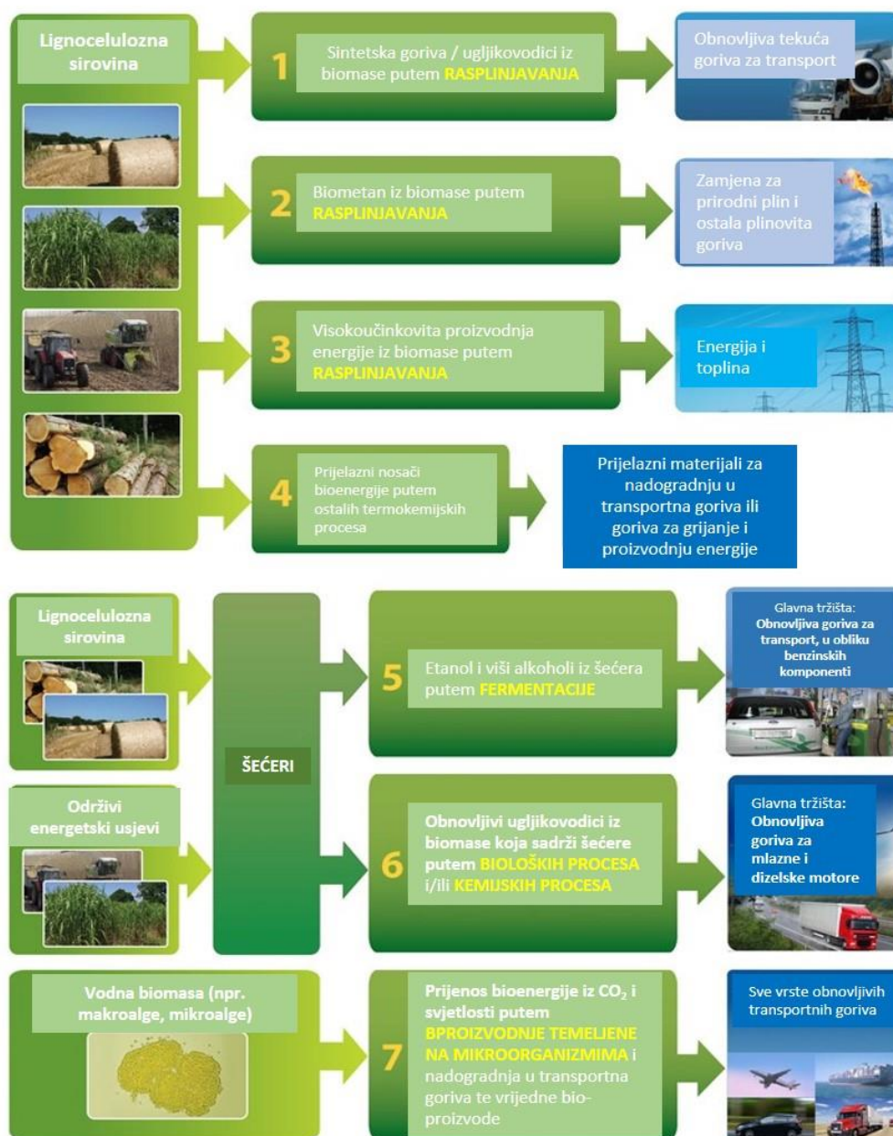
Slika 8.4. Vrijednosni lanci u primjeni tehnologija napredne konverzije biomase u biogoriva
